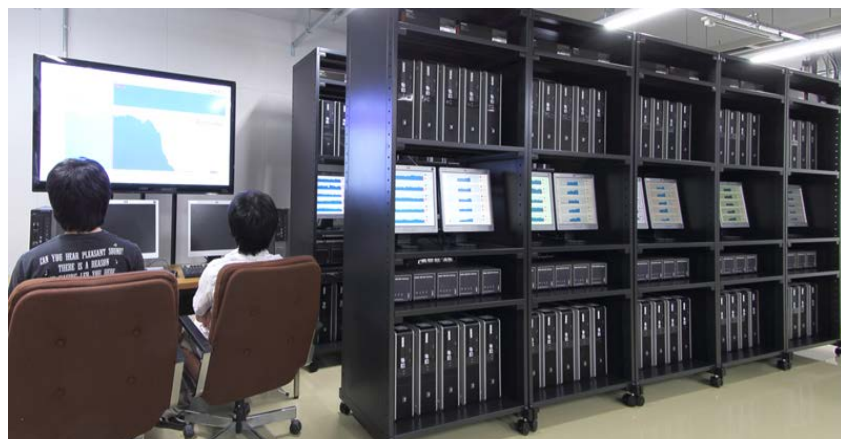
ビル用マルチエアコンのFastADRリアルタイムシミュレータ。 本当の通信プロトコルを稼働させて広域通信遅延を模擬。
